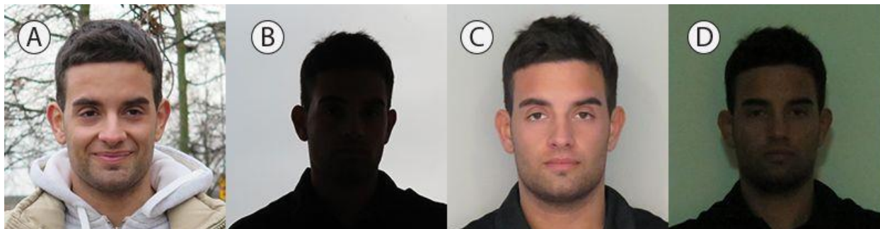
Рис. 4. Вплив освітлення на ідентифікацію об'єктів: А) освітленість близько 1600 лк та сприятливий напрям світла; В) освітленість 350 лк, але є фонове засвічення; С) освітленість 7 лк та сприятливий напрямок світла; D) освітленість 1,5 лк
