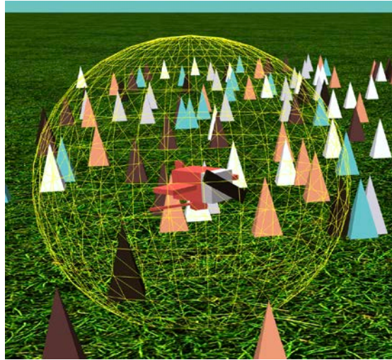
Рис. 2. Зона радіовидимості БпЛА у вигляді кулі
