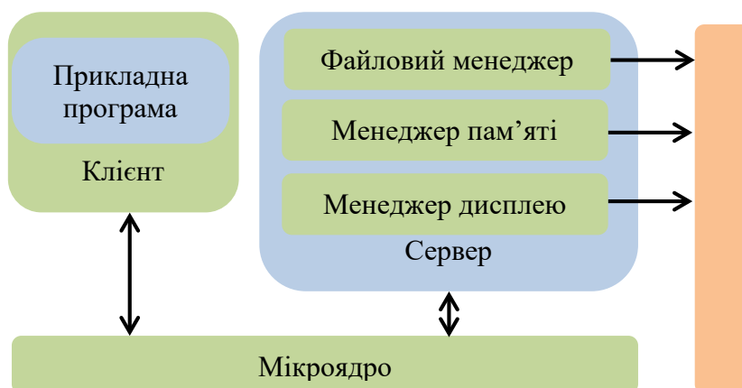
Рис. 3. Структурна схема ОСРЧ згідно з архітектурою “клієнт-сервер”
