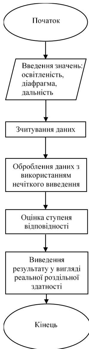
Рис. 5. Алгоритм визначення реальної роздільної здатності зображення IP-відеокамери з використанням теорії нечіткої логіки
