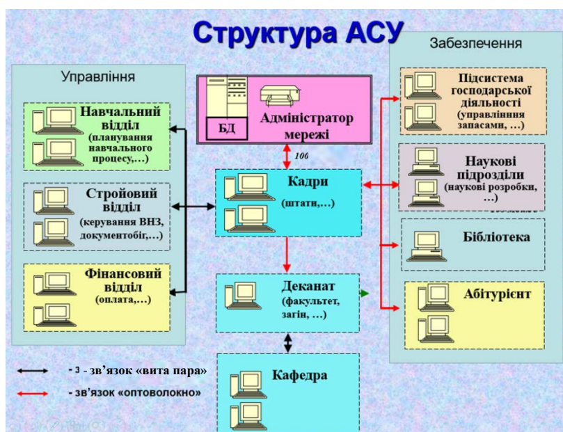
Рис. 1. Варіант базової технічної структури АСУ ВНЗ
